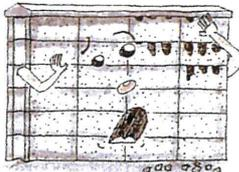
\*注6 中酸化とは、モルタルと炭酸ガスとの反応により、モルタルの中のアルカリ性が低下し、鉄筋の保護機能が失われる現象をいう。
