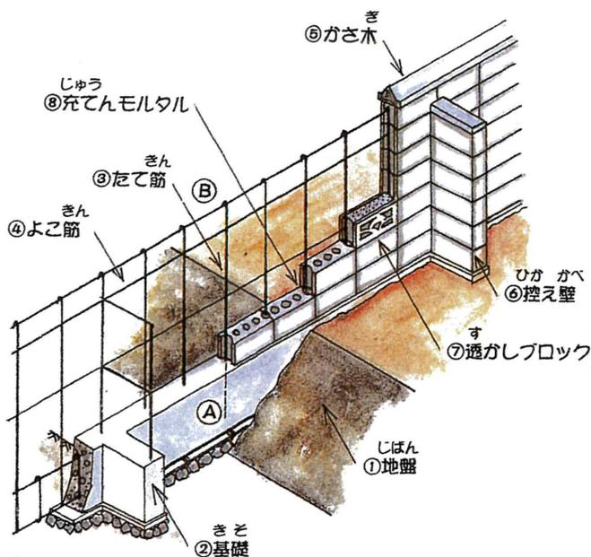
②基礎は、鉄筋コンクリートで堅固に造り、塀本体と一体となって転倒しないように、40cm以上地中に根入れします。さらに、抵抗力の大きい形式の基礎として、L形、T形及び鋼管杭打ち基礎などがあります。また、高い擁壁や石積みの上に設けられている塀は、基礎に粘りがなく非常に危険です。安全対策を講じて下さい。
