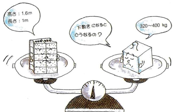
高さ1.6m、長さ1mのブロック塀の重さは、320~400kgです。例え、その破片であっても、私たちの力で支えられるものではありません。倒壊などにより、高いところから直撃を受けると、重大な事態が生じます。
